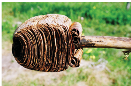
Kvevri brush made of the bark of bitter cherry tree Bürste aus Kirschbaumrinde Sartsxi - Brosse à Kvevri en écorce de merisier
