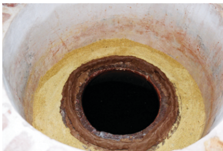
Kvevri top-attached clay Schon auf die Kvevrimündung geklebte Tonerde Application de l'argile sur le col du Kvevri
