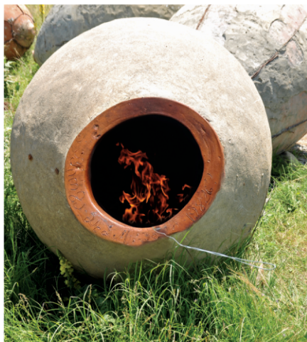
Kvevri heating before waxing Kvevriwärmen vor dem Einwachsen Chauffage de Kvevri avant le cirage
