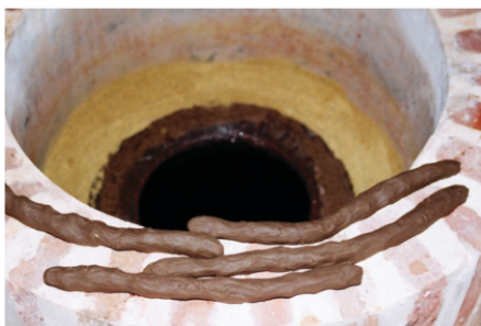
Kvevri top-attachable clay Die Tonerde, die auf die Kvevrimündung angebracht wird Application de l'argile sur le col du Kvevri
