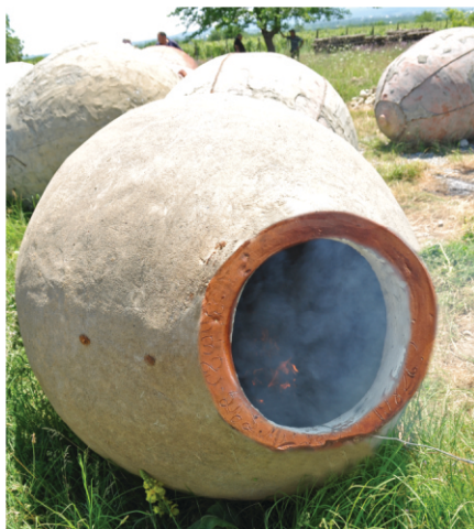
Kvevri heating before waxing Kvevriwärmen vor dem Einwachsen Chauffage de Kvevri avant le cirage
