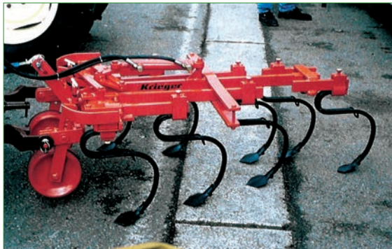
სურათი 10.3. მსუბუქი კულტივატორი ზამბარიანი ფიწლის თითებით
