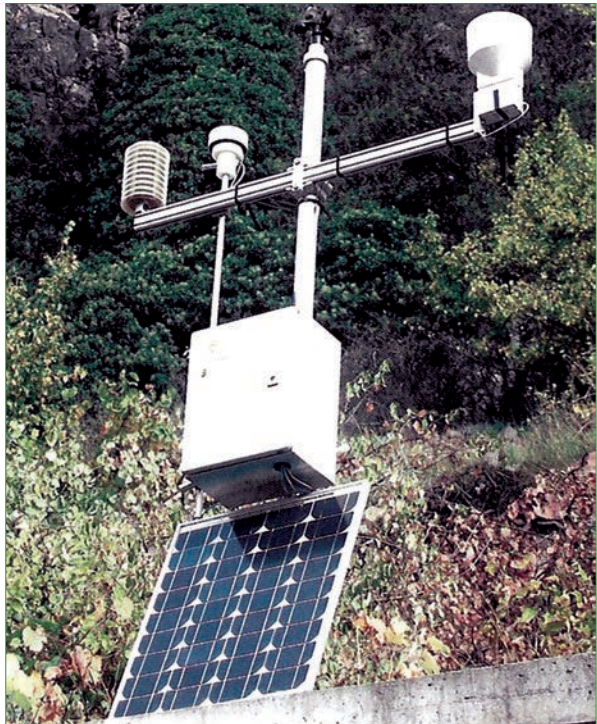
სურათი 2.6. მზის ენერჯიაზე მომუშავე მეტეოროლოგიური სადგური
