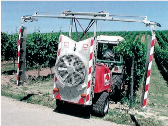
სურათი 10.48. ღერძული საქშენი დახურული საჰაერო სისტემითა და სტანდარტულზე მაღალი ბერკეტული მექანიზმით
