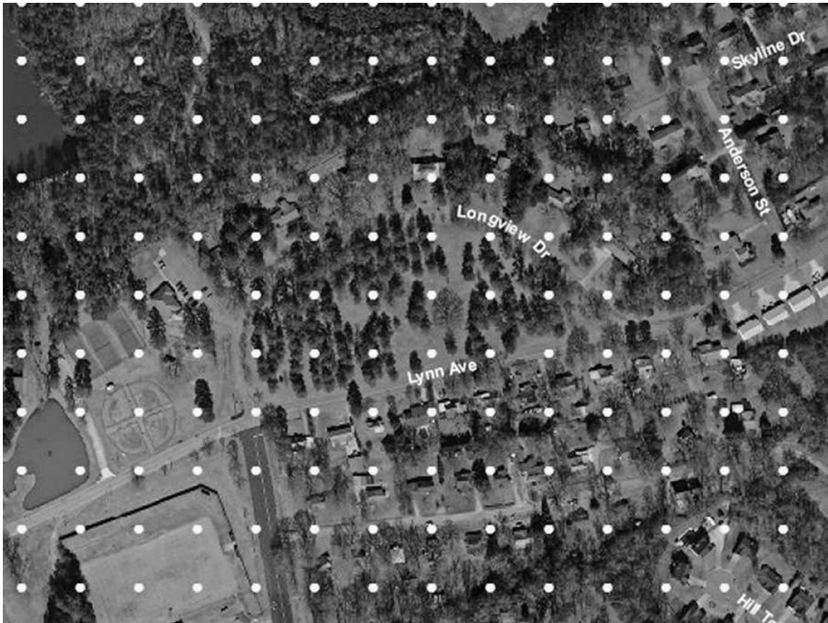
ნახატი 7-8 წერტილოვანი ბადის გამოყენებით ურბანული ხეების საბურველის ანალიზი. საბურველის დაფარულობის პროცენტული მაჩვენებლის გამოსათვლელად წინასწარ განსაზღვრულ ფართობზე, ხის ვარჯზე მოხვედრილი წერტილების რაოდენობა გაიყო ამ ზონაში მოხვედრილი წერტილების საერთო რაოდენობაზე (Courtesy of Connie Head, Technical Forestry Services).
