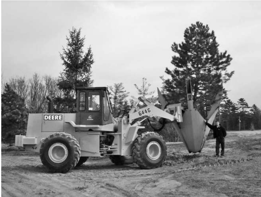
ნახატი 11-12 ხის დასარგავი ჰიდრავლიკური ნიჩბები შესაძლებელია გამოყენებულ იქნეს ქუჩაზე ხეების დასარგავად, სადაც მიწისქვეშა კომუნალური ქსელები არ არის (Courtesy of Dutchman Industries Inc., Dutchman model 330i tree spade).
